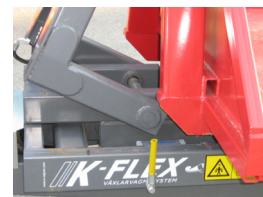
Riktmärke höger chassibalk
